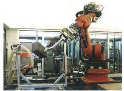
図2—ロボットによるスタイロフォームの切断風景 ©Gramazio & Kohler, ETH Zürich
